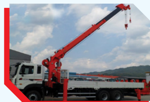
Cẩu tự hành 25 tấn
